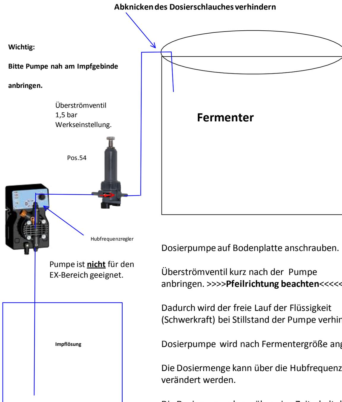
Dosierpumpe auf Bodenplatte anschrauben.
